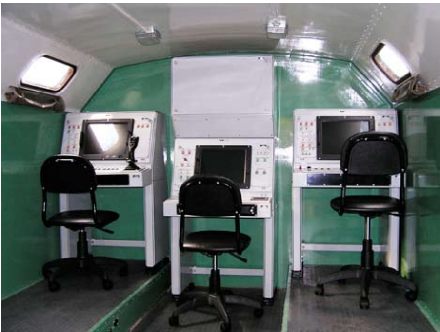
Wnętrze kontenera prototypowego stanowiska dowodzenia A3. Dobrze widoczne konsole dowódcy (środkowa) oraz operatorów (boczne). Na zbliżeniu jedna z konsol operatorskich z wyświetlaczem ciekłokrystalicznym i joystickiem.
