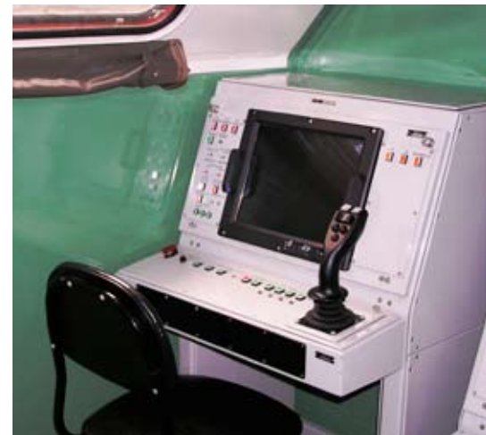
Wnętrze kontenera prototypowego stanowiska dowodzenia A3. Dobrze widoczne konsole dowódcy (środkowa) oraz operatorów (boczne). Na zbliżeniu jedna z konsol operatorskich z wyświetlaczem ciekłokrystalicznym i joystickiem.
