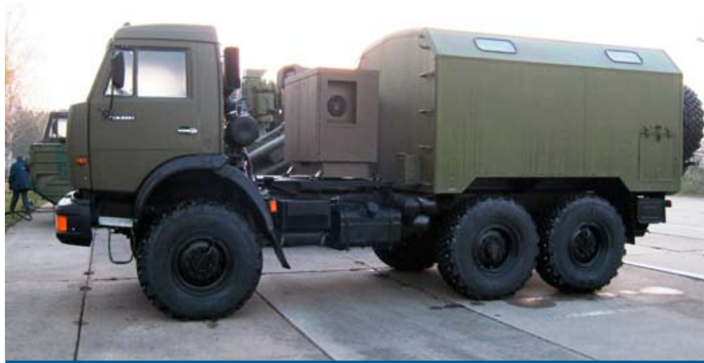
Pierwszy, zrealizowany „w metalu”, wariant stanowiska dowodzenia systemu A3. W prezentowanej postaci nie zostało ono w pełni skompletowane - brakuje składanego masztu z głowicą elektrooptyczną między szoferką a kontenerem.
