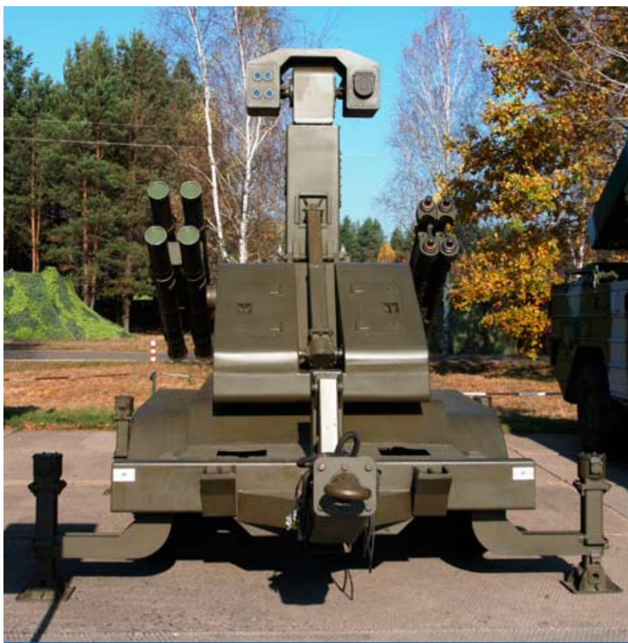
Prototypowy moduł bojowy A3 integruje głowicę elektrooptyczną oraz wyrzutnie ppk i rakiet przeciwlotniczych, nie zamontowano uzbrojenia lufowego. Całość umieszczono na dwuosiowej przyczepie holowanej przez samochód.
