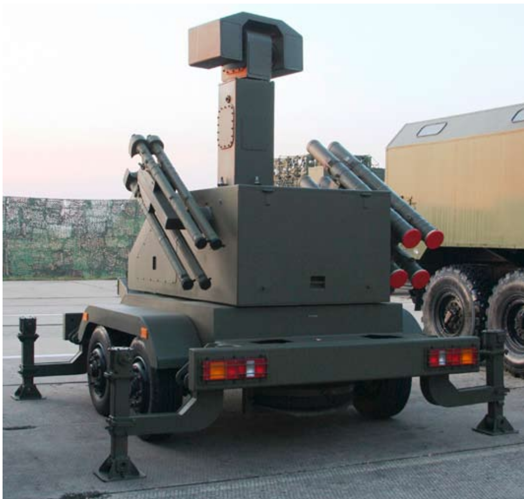
Prototypowy moduł bojowy A3 integruje głowicę elektrooptyczną oraz wyrzutnie ppk i rakiet przeciwlotniczych, nie zamontowano uzbrojenia lufowego. Całość umieszczono na dwuosiowej przyczepie holowanej przez samochód.
